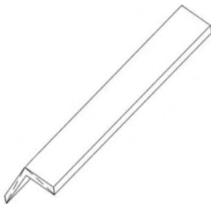
Anfangs- und Endleiste für Lamellen 36,5 x 56 mm
