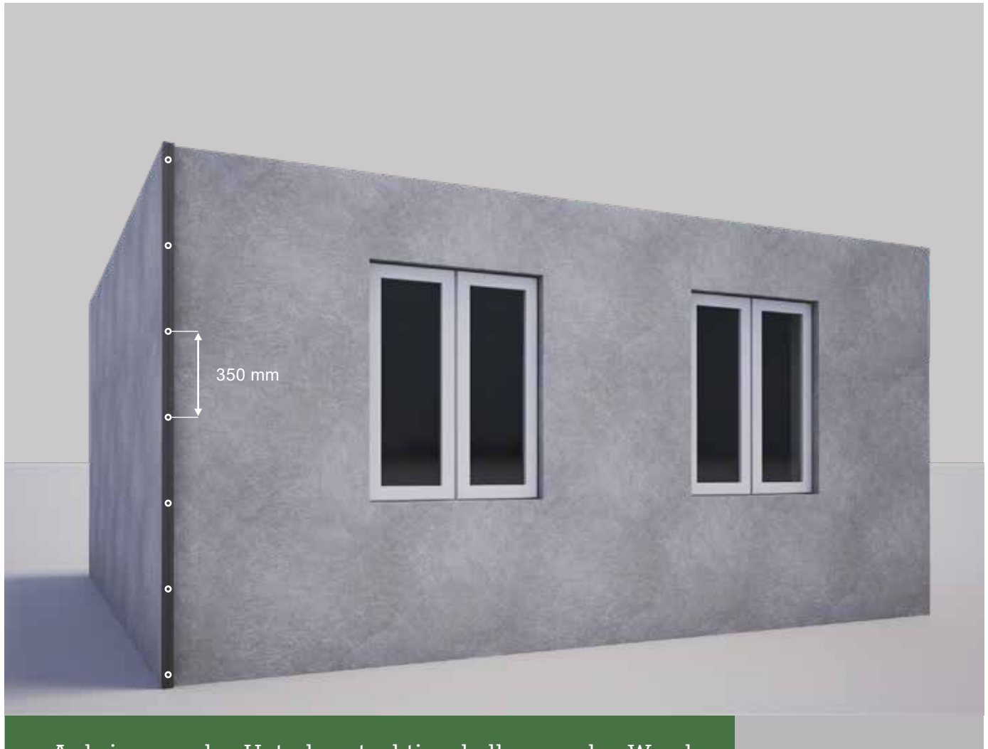
Anbringung der Unterkonstruktionsbalken an der Wand
